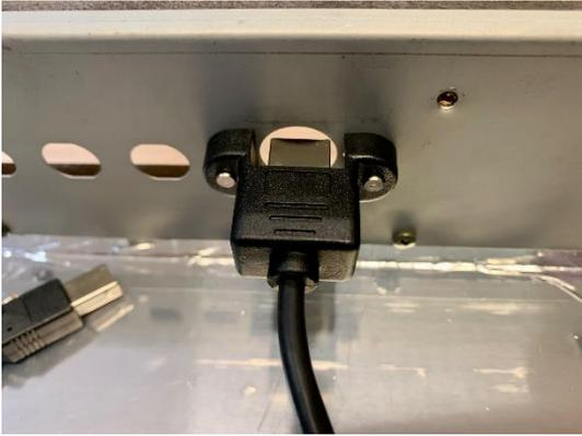
Wo sich die Buchse für das Expression-Pedal befand, wird die USB-Buchse in die Rückwand eingebaut. Bohren Sie dafür zwei 3mm-Löcher in passendem Abstand (29 mm) dicht neben den vorhandenen Bohrlöchern oder erweitern sie diese mit der Rundfeile.
