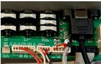
Bei einigen XB2 findet man statt des 8-poligen Steckverbinders für PL13 einen 3-poligen und einen 4-poligen vor. Bitte gehen Sie dann so vor: Drücken Sie die Widerhaken der Steckkontakte mit einem spitzen Gegenstand vorsichtig herunter und ziehen Sie die Kabel mit dem Kontakt aus dem Gehäuse. Suchen Sie einen 8-poligen Verbinder aus dem ausgebauten Kabelbaum heraus und entfernen Sie auch bei diesem die Steckkontakte.
