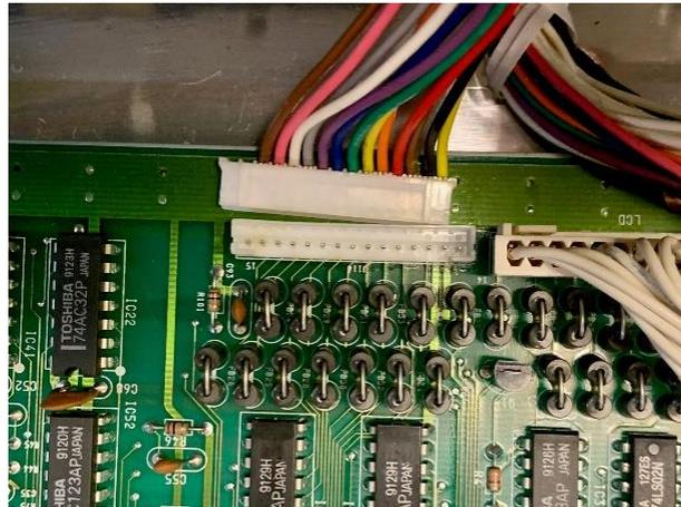
Lösen Sie vor dem Abnehmen der Tastatur den Anschluss von der Hauptplatine.
