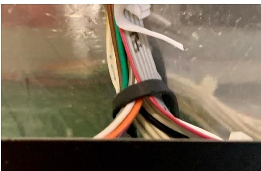
Fixieren Sie die Kabel zum Display und den Buttons an der Front eng mit dem Kabelhalter.
