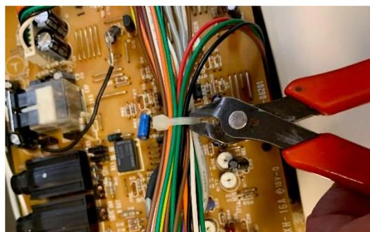
Entfernen Sie alle Kabelbinder, die verschiedene Kabelstränge zusammenhalten.
