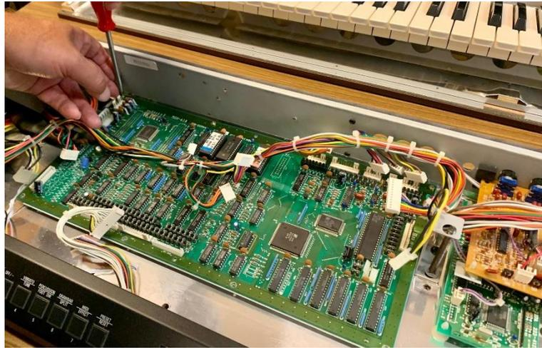
Lösen Sie alle Steckverbinder und bauen Sie die große Hauptplatine und die rechts daneben befindlichen Platinen aus.
