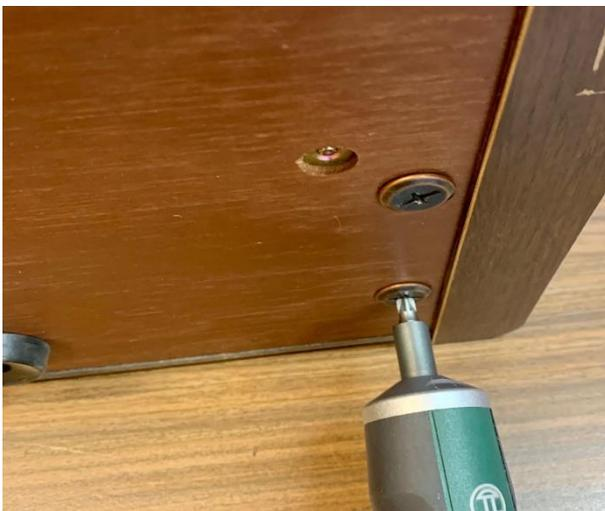
Lösen Sie die 5 großen Schrauben an der Unterseite.
