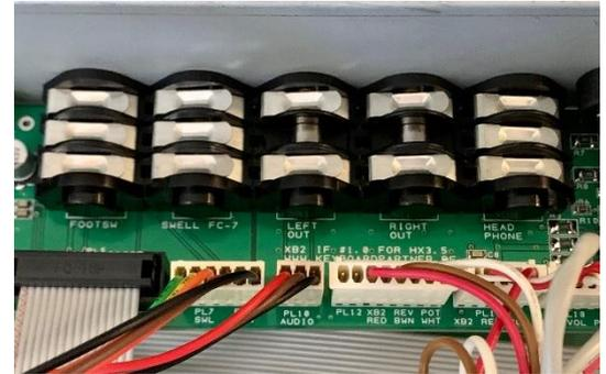
Der Anschluss der Interface-Platine 1 ist damit bis auf die Stromversorgung fertiggestellt und sollte so aussehen wie auf dem nebenstehenden Foto.
