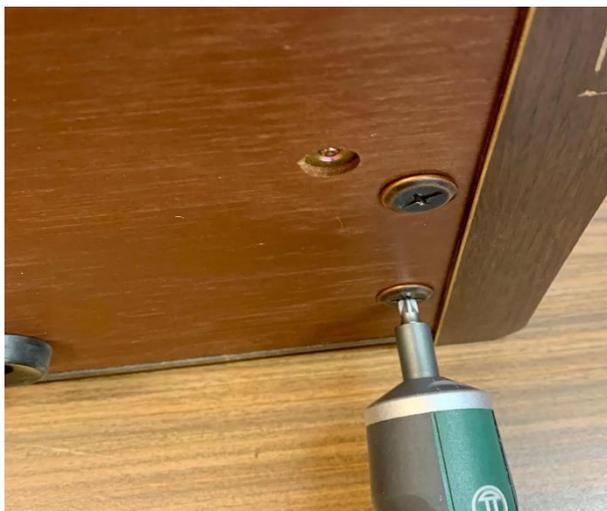
Lösen Sie die 5 großen Schrauben an der Unterseite. Dann lässt sich der Holzdeckel abnehmen.
