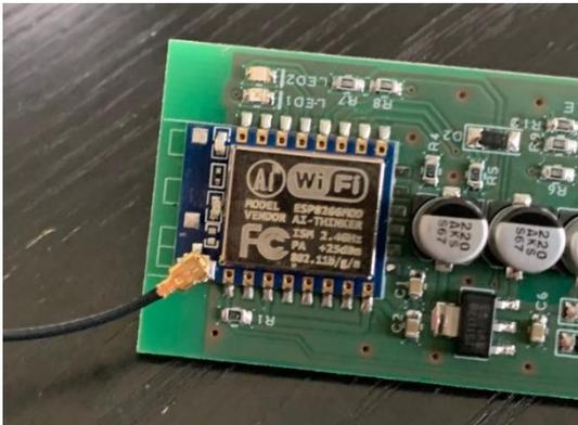
Drücken Sie den Stecker des Antennenkabels vorsichtig auf die Antennenbuchse des WLAN-Moduls, bis er fest einrastet.
