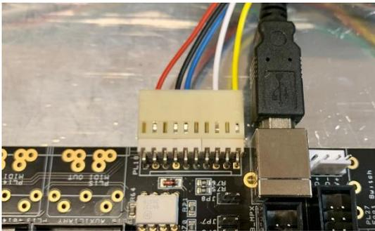
Verbinden Sie das mitgelieferte Kabel mit den weißen 10pol. Steckverbindern mit PL20 auf dem Mainboard und PL19 auf der Interface-Platine 1. Achtung: Die Stecker sind unterschiedlich belegt. Achten Sie darauf, dass die Kabelfarben mit der Abbildung links übereinstimmen.
