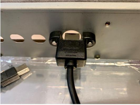
Installez la prise USB dans le panneau arrière, à l'emplacement du connecteur de pédale d'expression. Pour cela, percez deux trous de 3 mm à une distance appropriée près des trous de perçage existants ou élargissez cela avec la lime ronde.
