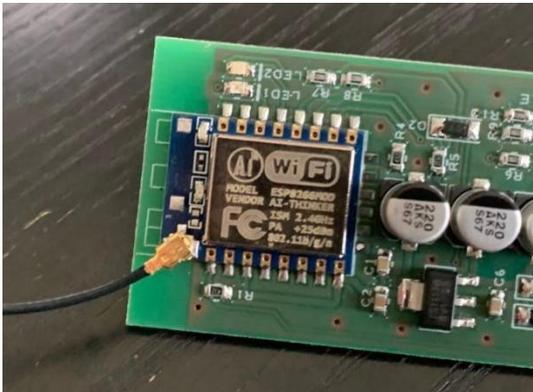
Appuyez avec précaution la fiche du câble d'antenne sur la prise d'antenne du module WLAN jusqu'à ce qu'elle s'enclenche fermement.
