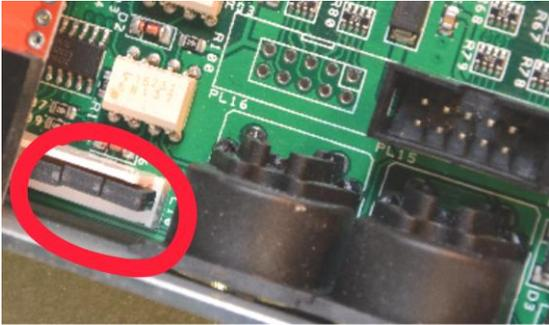
HX3 MIDI Expander sind gewöhnlich ab Werk für Phantomspeisung vorbereitet. Verbinden Sie das 5-polige MIDI-Kabel mit MIDI IN/OUT auf dem HX3.5 Mainboard und MIDI OUT des HX3 Drawbar Controllers. Jetzt sollte der HX3 Drawbar Controller vom HX3 MIDI Expander mit Strom versorgt werden. Ist das nicht der Fall, setzen Sie zwei Jumper auf dem Steckverbinder für die MIDI-Konfiguration PL18 auf die Positionen 7-8 und 9-10, wie im Foto zu sehen.
