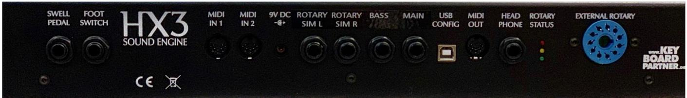
**SWELL PEDAL** (Stereo-Klinke) – Eingang für Fußschweller kompatibel mit Yamaha FC7 oder kompatibler Typen (Stecker-Spitze = Potentiometer-Ende, Ring = Schleifer-Anschluss), Widerstandswert 10 bis 50 kOhm.
