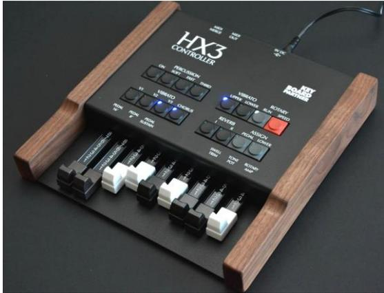
Der **HX3 Drawbar Controller** wurde entwickelt zur Nutzung mit dem **HX3 MIDI Expander** oder anderen Orgel-Modulen, die mit Native Instruments B4® kompatibel sind. In einem speziellen Modus ermöglicht er auch die Steuerung von Nord C2-Orgeln. Er mischt die am Eingang MIDI MERGE eingehenden MIDI-Daten mit seinen eigenen Controller-Daten.
