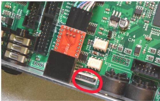
Entfernen Sie vier Kreuzschlitzschrauben an der Rückwand und ziehen Sie das Chassis vorsichtig einige Zentimeter heraus. Stecken Sie die beiden Jumper auf die Positionen 7-8 und 9-10 des Steckverbinders **PL10** beim **HX3 mk4** Mainboard beziehungsweise **PL18** bei **HX3.5** Mainboard, wie im Bild gezeigt. Schrauben Sie die Rückwand wieder an
