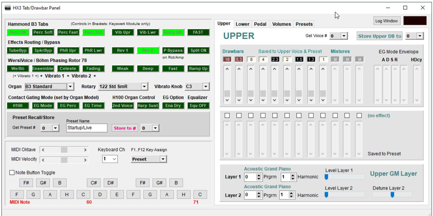
Mit dem Panel können Sie das HX3-Gerät über virtuelle Bedienelemente steuern. Sie können Orgel- und Rotary-Modelle wählen, Sounds und Effekte einstellen sowie Presets erzeugen, benennen und abspeichern. Wenn das Panel-Fenster geöffnet ist, können Sie Presets live über die Funktionstasten Ihrer PC-Tastatur aufrufen.
