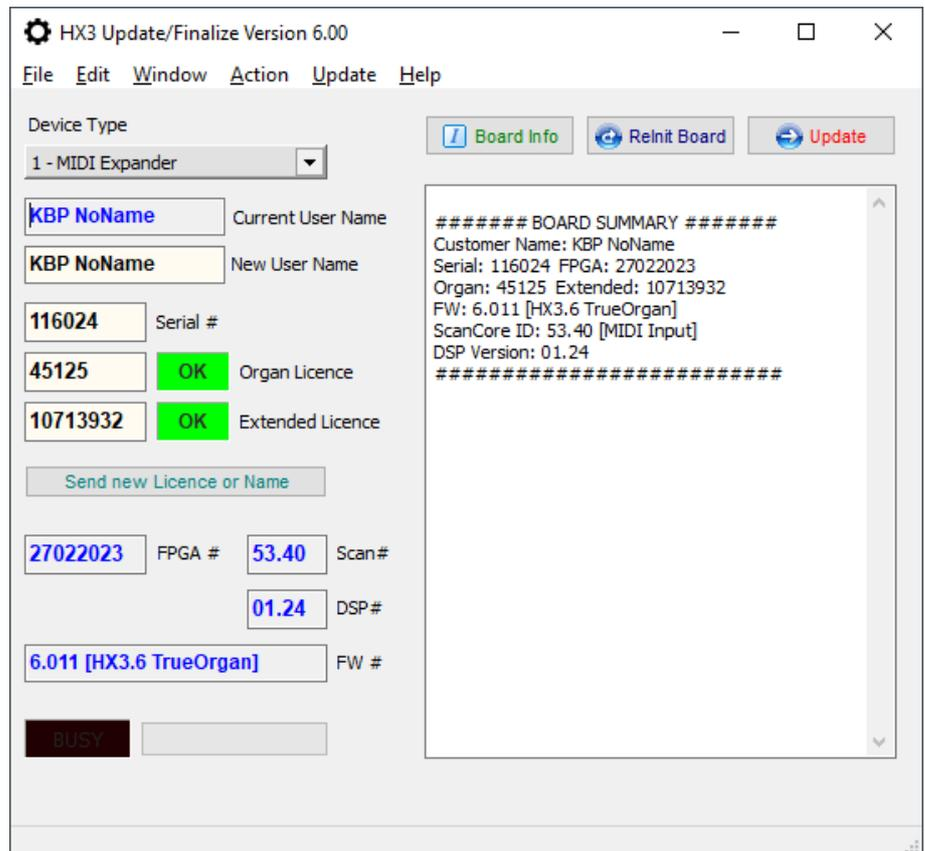
**Prüfen Sie beim Einbau einer neuen HX3-Platine zuerst die Grundeinstellungen. Die *System Inits* sind ab Werk normalerweise für die Verwendung als MIDI Expander voreingestellt.**
