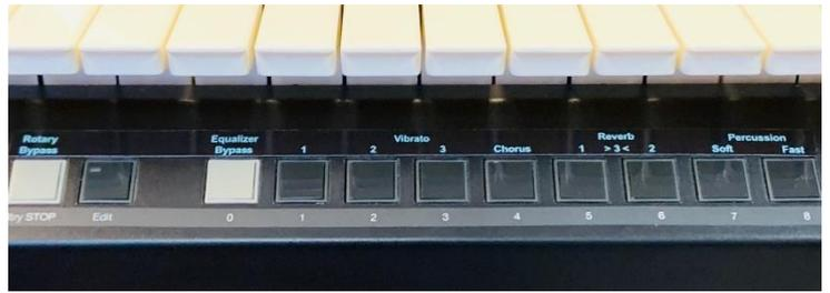
**Vibrato ON** schaltet Vibrato ein/aus. Synchron mit der Zugriegelzuweisung wird Vibrato auf das Untermanual geschaltet, wenn die LED in der Taste Drawbars U | L | P leuchtet.
