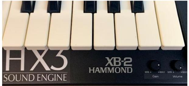
Die Belegung der Potis kann im Editor des HX3.6 Managers mittels der Analog Remap Parameter nach Belieben geändert werden. So können Sie diese zum Beispiel mit den Funktionen Reverb Level und Percussion Level belegen.
